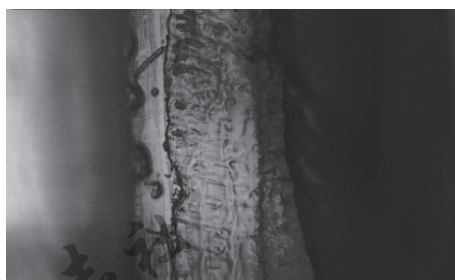
图4 超声波焊接后样条PMMA段表面形貌SEM照片
